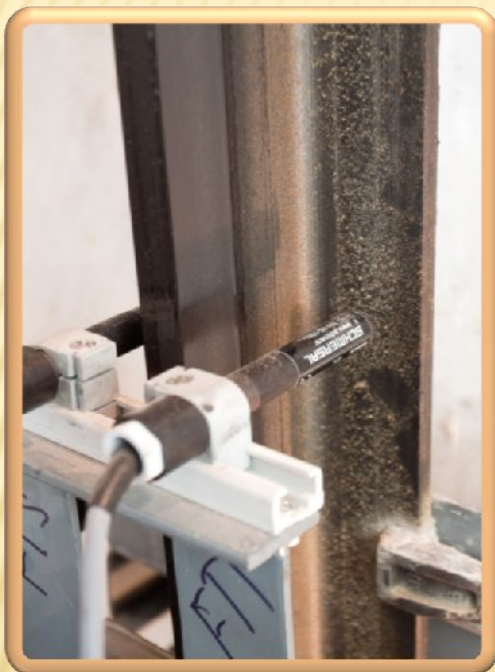
magnetický snímač, zabezpečujúci presné zastavenie
